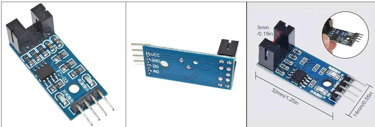
**Módulo/Tacómetro:** Este sensor de velocidad, chip LM393, tiene un voltaje de trabajo CC que oscila entre 3.3 - 5 V, y el comparador nos brinda una señal de salida del limpia, con buena forma de onda, y tiene capacidad de conducción, y un muy bajo consumo.
