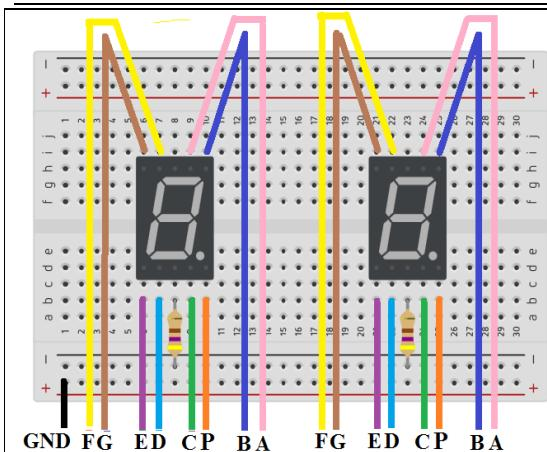
**Lista de Materiales:** 2 Display 7 Segmentos de 0.56" Cátodo Común (No importa color), 2 Resistencia de 470Ω, 17 cables conectores macho/macho, 1 Placa Protoboard - Placa Arduino y 1 Cable USB.
