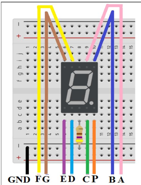
**Lista de Materiales:** 1 Display 7 Segmentos de 0.56" Cátodo Común (No importa color), 1 Resistencia de 470Ω, 9 cables conectores macho/macho, 1 Placa Protoboard - Placa Arduino y 1 Cable USB.
