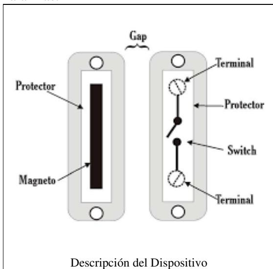
Estos sensores constan de un imán y un reedswitch (interruptor magnético).
