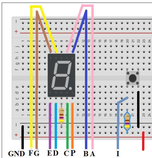
**Lista de Materiales:** 1 Display 7 Segmentos de 0.56" Cátdodo Común (No importa color), 2 Resistencia de 470Ω, 1 Botón Pulsador de 2 Patas, 12 cables conectores macho/macho, 1 Placa Protoboard - Placa Arduino y 1 Cable USB.
