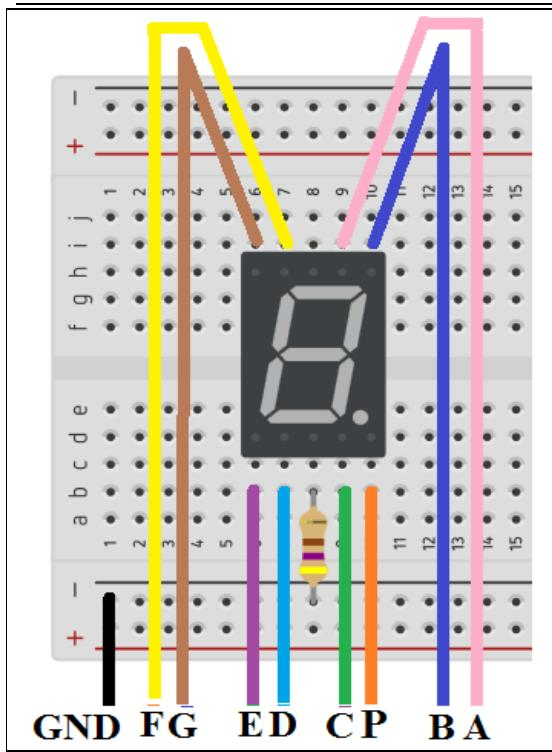
**Lista de Materiales:** 1 Display 7 Segmentos de 0.56" Cátodo Común (No importa color), 1 Resistencia de 470Ω, 9 cables conectores macho/macho, 1 Placa Protoboard - Placa Arduino y 1 Cable USB.
