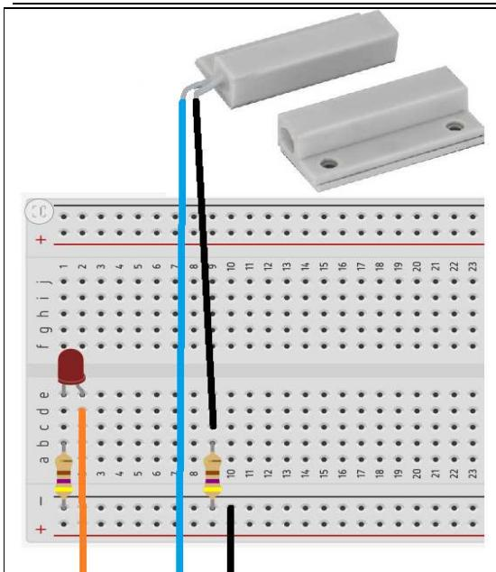
**Lista de Materiales:** 1 Sensor magnético para puertas y ventanas, 1 Placa Protoboard, 1 Led rojo, 2 Resistencias de 470Ω, cables conectores.
