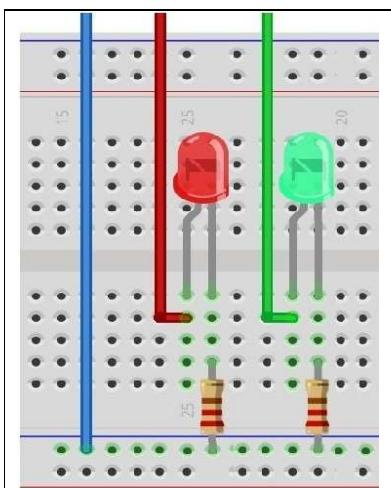
**Lista de Materiales:** 1 Placa Protoboard - 2 LED - 2 Resistencia de  $470\Omega$  - 3 Cables Macho-Macho - 1 modulo **Ethernet Shield W5100** - cable Ethernet para conectarnos a nuestro Modem, router o switch, 2 Metros, 1 Tarjeta Micro SD con adaptador (Máx. 16Gb) 1 Placa Arduino y 1 Cable USB -
