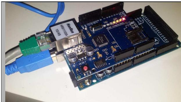
**Lista de Materiales:** 1 modulo Ethernet Shield W5100 - cable Ethernet para conectarnos a nuestro Modem, router o switch, 2 Metros, 1 Placa Arduino y 1 Cable USB.
