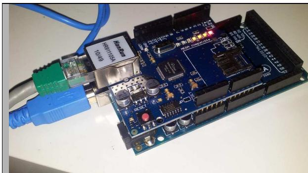
**Lista de Materiales:** 1 modulo Ethernet Shield W5100 - cable Ethernet para conectarnos a nuestro Modem, router o switch, 2 Metros, 1 Tarjeta Micro SD con adaptador (Máx. 16Gb), 1 Placa Arduino y 1 Cable USB.
