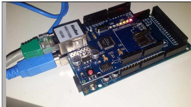
**Lista de Materiales:** 1 Modulo Ethernet Shield W5100 - cable Ethernet para conectarnos a nuestro Modem, router o switch, 2 Metros, 1 Placa Arduino y 1 Cable USB.
