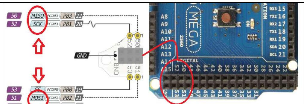
Por ejemplo, uno de los modelos más difundidos que no se acoplan directamente con Arduino es el **Ethernet w5100** con placa (tablero) roja o azul. Este modelo, además de no poder acoplar directamente, no tiene una Lectora/Grabadora SD o Micro SD y los precios son muy similares. **Así serán las conexiones:**
