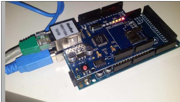
**Lista de Materiales:** 1 modulo Ethernet Shield W5100 - cable Ethernet para conectarnos a nuestro Modem, router o switch, 2 Metros, 1 Tarjeta Micro SD con adaptador (Máx. 16Gb) 1 Placa Arduino y 1 Cable USB -
