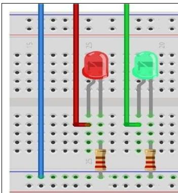
**Lista de Materiales:** 1 Placa Protoboard - 2 LED - 2 Resistencia de 470Ω - 3 Cables Macho-Macho - 1 modulo **Ethernet Shield W5100** - cable Ethernet para conectarlos a nuestro Modem, router o switch, 2 Metros, 1 Placa Arduino y 1 Cable USB - Placa Arduino.
