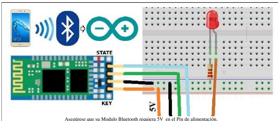
**A tener en cuenta:** deberemos conectar el modulo Bluetooth, en los pines RX y TX, que son los puertos por donde Arduino se conecta con el monitor del puerto serie. Lamentablemente por ahora debemos elegir si conectamos el modulo Bluetooth o enviamos y recibimos datos desde y hacia el monitor. A así que a prestar mucha atención. Luego solucionaremos este problema.
