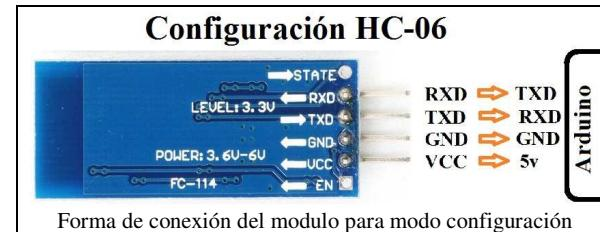
Forma de conexión del modulo para modo configuración
