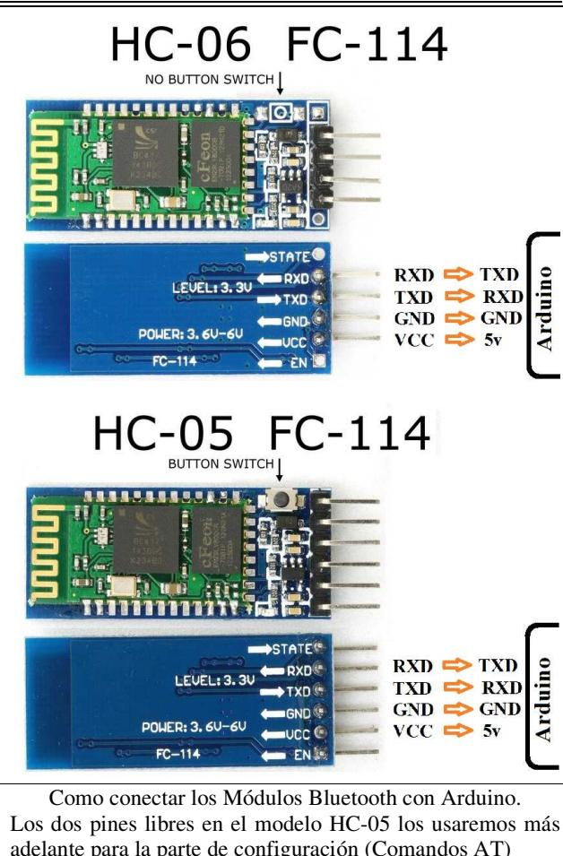
Como conectar los Módulos Bluetooth con Arduino. Los dos pines libres en el modelo HC-05 los usaremos más adelante para la parte de configuración (Comandos AT)
