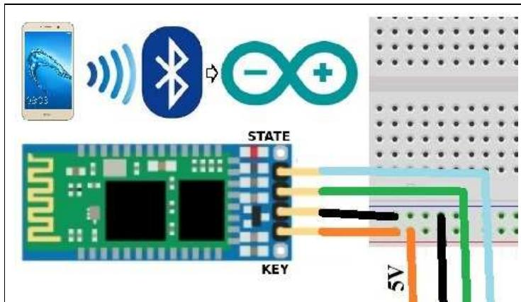
**Los cables deberán ser conectados:** Abajo, de Izquierda a Derecha, Cable Naranja: a 5v de Arduino. Cable Negro a GND. Cable Verde: Corresponde en Modulo Bluetooth a TX y se debe conectar al RX de Arduino (PIN 11 adicional RX en Arduino). Cable Celeste, del RX del Modulo Bluetooth a TX de Arduino (PIN 10 adicional TX en Arduino). **Si te queda alguna duda como se conectan los pines RX y TX, simplemente debes conectarlos en forma cruzada (RX con TX y TX con RX).**
