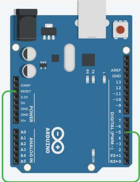
**Los cables deberán ser conectados:** Como se muestran en la imagen del circuito, desde el pin 5 directo al Pin Reset y el cable USB desde Arduino a La PC.
