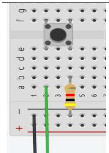
**Lista de Materiales:** 1 Botón Pulsador (de 2 o 4 Patas) - 1 Resistencia de  $470\Omega$  - 1 Protoboard - 2 Cables de conexión Macho/Macho - Placa Arduino y 1 Cable USB.
