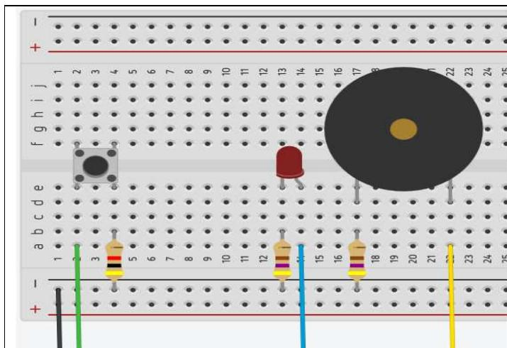
**Lista de Materiales:** 1 Botón Pulsador (de 2 o 4 Patas) – 1 Speaker - 1 Led - 3 Resistencias de  $470\Omega$  - 1 Protoboard - 4 Cables de conexión Macho/Macho - Placa Arduino y 1 Cable USB.
